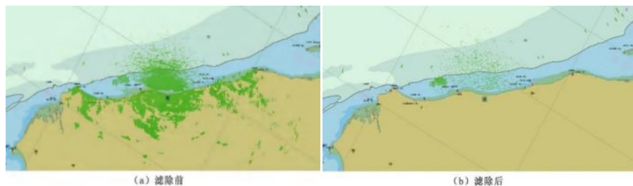
图1 雷达自适应固定地物杂波滤除效果图
